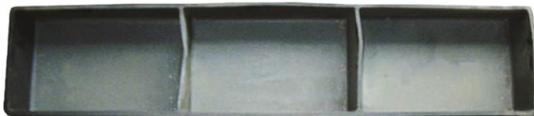
Рис. 6.1. Эластичный резиновый лоток для определения потерь зерна за комбайном
