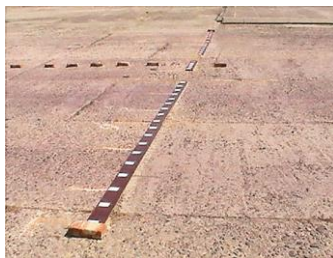
Рис. 5.3. Схема расположения учетных карточек при проведении лабораторных опытов на открытой площадке
