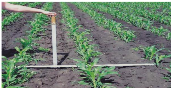
Рис. 2.3. Определение гребнистости дна обработанного междурядья
